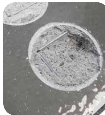
Teste de Arrancamento sobre base de concreto 100% falha do concreto (ASTM D-4541)
