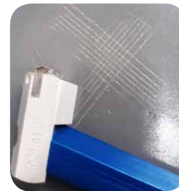
Teste de Adesão sobre chapas de aço 100% de aderência (ASTM D-3359)
