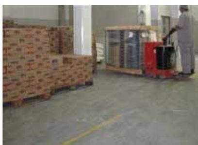
Arrastes causados por objetos ponteados marcarão e desgastarão inicialmente o acabamento, e dependendo do objeto, todo o sistema. O uso de pneus adequados e a atenção na condução do equipamento, reduzirão as marcas no piso. Ao desgastar o acabamento, é um sinal de desgaste da eventual camada de sacrifício de seu piso. A camada de acabamento poderá ser reaplicada a um custo inferior ao do investimento inicial, garantindo a longevidade do seu piso.
