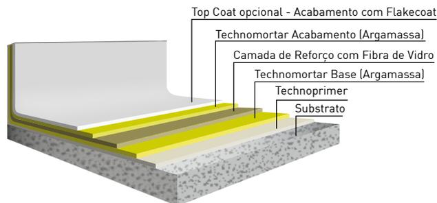
Linha de revestimentos formulados com cargas minerais especiais, formando uma argamassa de grande rigidez, além de alta resistência química e mecânica.
